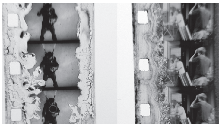
Detalhes de película com perda de emulsão nas bordas
