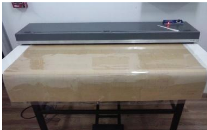
Figura 4: planta com o invólucro sendo selado na máquina de solda.
