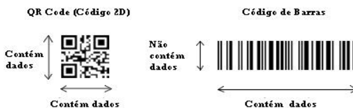
Figura 2. Exemplo de um QR code e um código de barras. Figura traduzida de DENSO WAVE INCORPORATE (2009)
