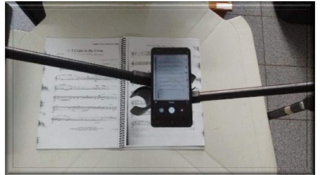
Estrutura para Digitalização através do celular por Fotografia
