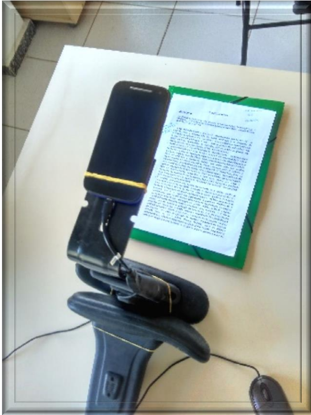
Digitalização através do celular (Usando aplicativo; mouse adaptado)
