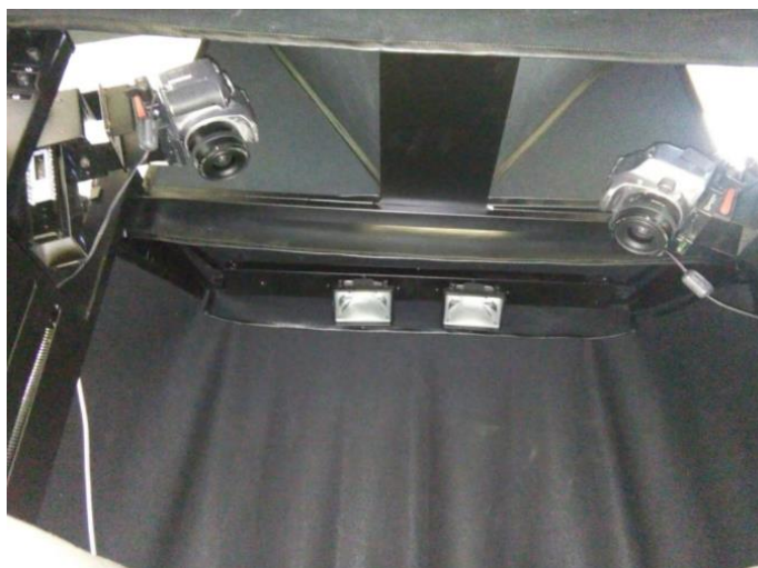
Figura 5. Equipamento de digitalização bookdrive Pro visto de baixo para cima
