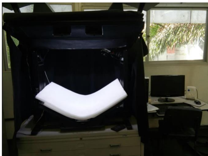
Figura 4. Equipamento de digitalização bookdrive Pro visto de frente
